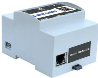
Gateway bidirezionale per le centrali antintrusione Risco (LightSYS, ProSYS, ProSYS plus con scheda di rete) e Eib/Knx IP (DPT 1 bit e 8 bit configurabili) o ModBus IP (ModBus slave 16 bit read/write). Funzione gateway fino a 2.500 punti bidirezionali. Il gateway è configurabile per il funzionamento in modalità EIB/ KNX IP o in modalità ModBus IP.
